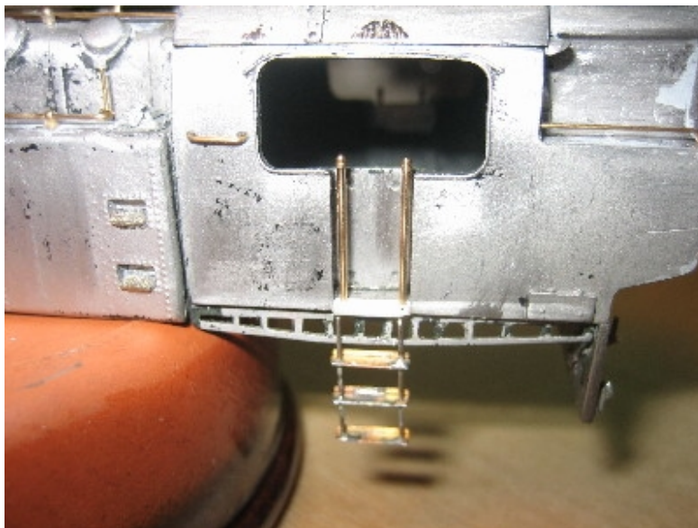
Les jolies mains-montoirs Apogée Vapeur (pour 040 TA Ouest...) et les marchepieds Carmina.
